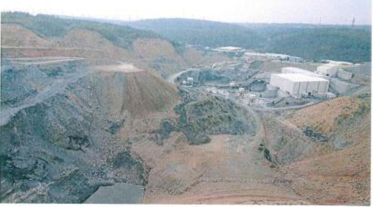
Şekil 4. Agregga (Kumtaşı) maden alanının genel görüntüsü. Sahada yapılan açık işleme faaliyeti sonucunda, kazı alanında belirli kademeler oluşmuş, kapalı alanlar oluşturulan kırma-eleme tesisleri kurulmuştur.
