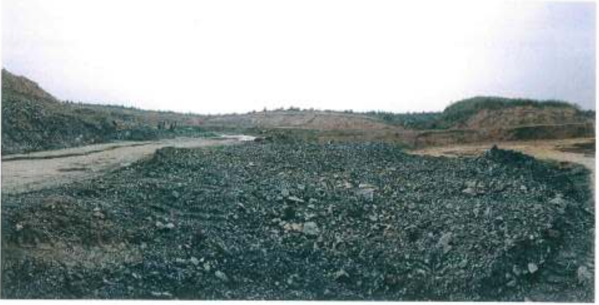
Şekil 6. Ocak işletme alanı kum içinde kumtaşı görüntüsü. Yeni üretim alanının oluşturulmasında dekapaj çalışmaları devam etmektedir.
